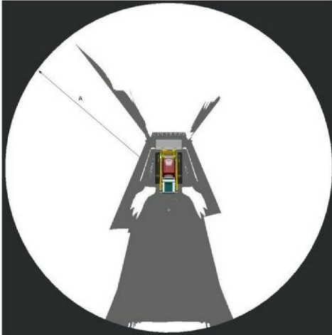
Рисунок 1 g06338806 Вид сверху машины с закрытой кабиной, обзор на уровне земли. (A) 12 m (39 ft)
